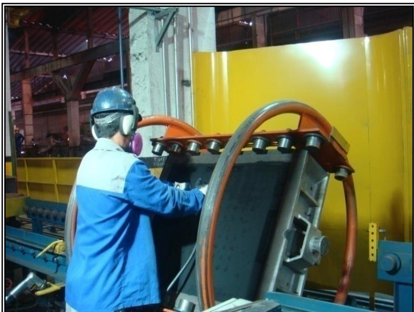
Moldagem em areia
